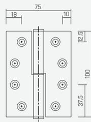
**J0630SSS** LIFT OFF HINGE LEFT HAND 100X75X2.5MM SSS
